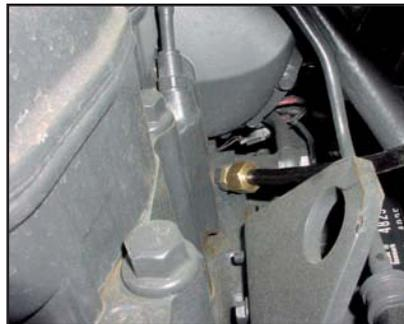
OLC имеет множество преимуществ по сравнению с другими системами наполнения моторным маслом. Наполнение происходит „сверху“ через подвод или крышку вентиля. Исключается утечка масла. OLC представляет собой компактную закрытую систему.
