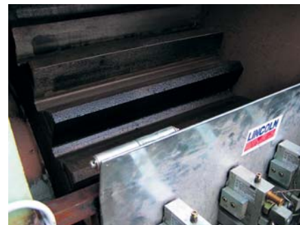
Фото 3 Пример распыления смазки на приводную шестерню мельницы
