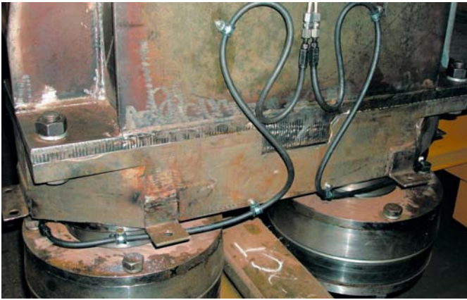
Фото 4 Подвод смазки к подшипнику упорного ролика (петля на шланге позволяет регулировать положение ролика относительно рельса)
