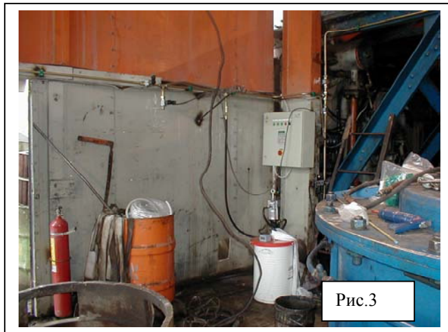
Рис.3 Общий вид бочечного насоса и размещение его в машинном отделении ЭШ 15.90
